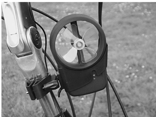
In de Mini Kin zit een windmolen die verbonden is met een ingebouwde dynamo. Zo wordt de bewegingsenergie van de molen omgezet in elektrische energie. Met deze elektrische energie wordt een accu opgeladen.
